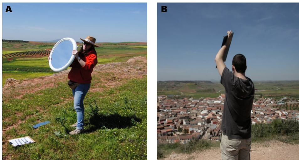
Fig. 5: Señales ópticas: experimentación diurna. Ejemplo de espejo (A) y de chapa metálica pulida (B) utilizados.
